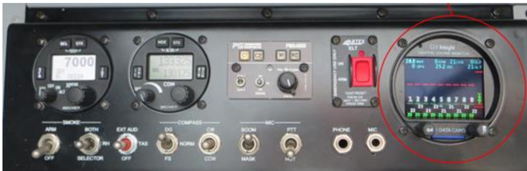
Obr. 8 – Display Engine Monitoring System v červeném kruhu
