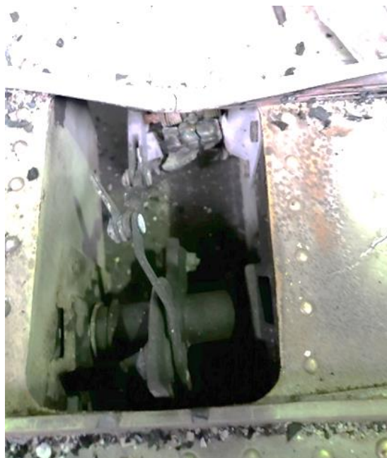
Obr. 17 – Hák zámku pravé podvozkové nohy
