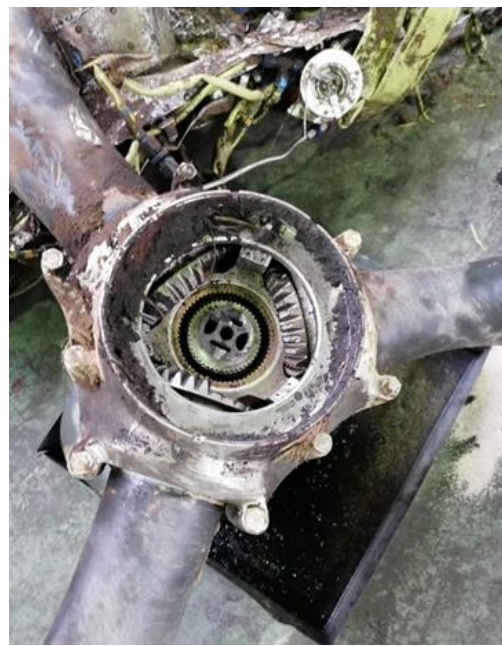
Obr. 14 – Mechanismus stavění listů ve vrtulové hlavě.
