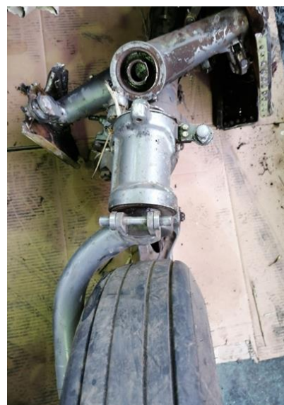
Obr. 15 – Poškození přední podvozkové nohy.
