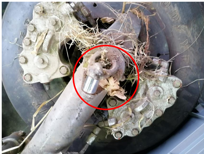
Obr. 19 – Dřevěné třísky zaklíněné v oku zámku levé podvozkové nohy
