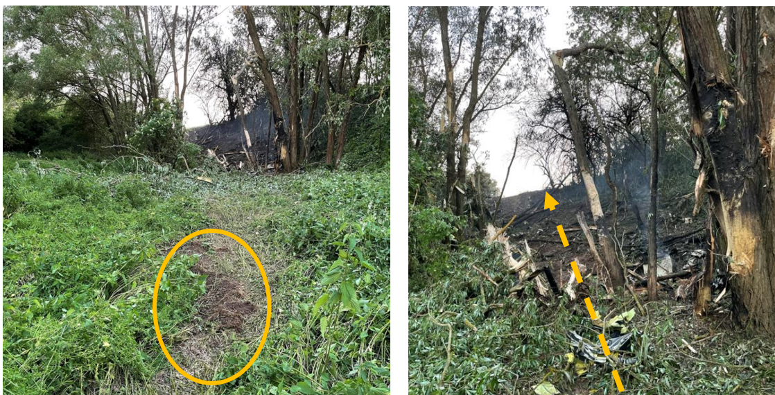
Obr. 10 – Kontakt pneumatiky kola předového podvozku letounu se zemí (vlevo) a místo nárazu letounu do stromů ve stoupajícím reliéfu terénu (vpravo), šipka ukazuje směr pohybu trosk po nárazu
