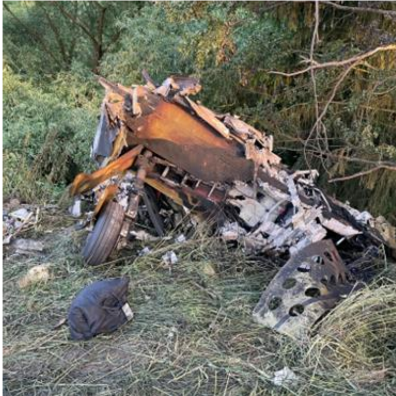
Obr. 16 – Trosky (torzo) letounu po dopadu zničené požárem
