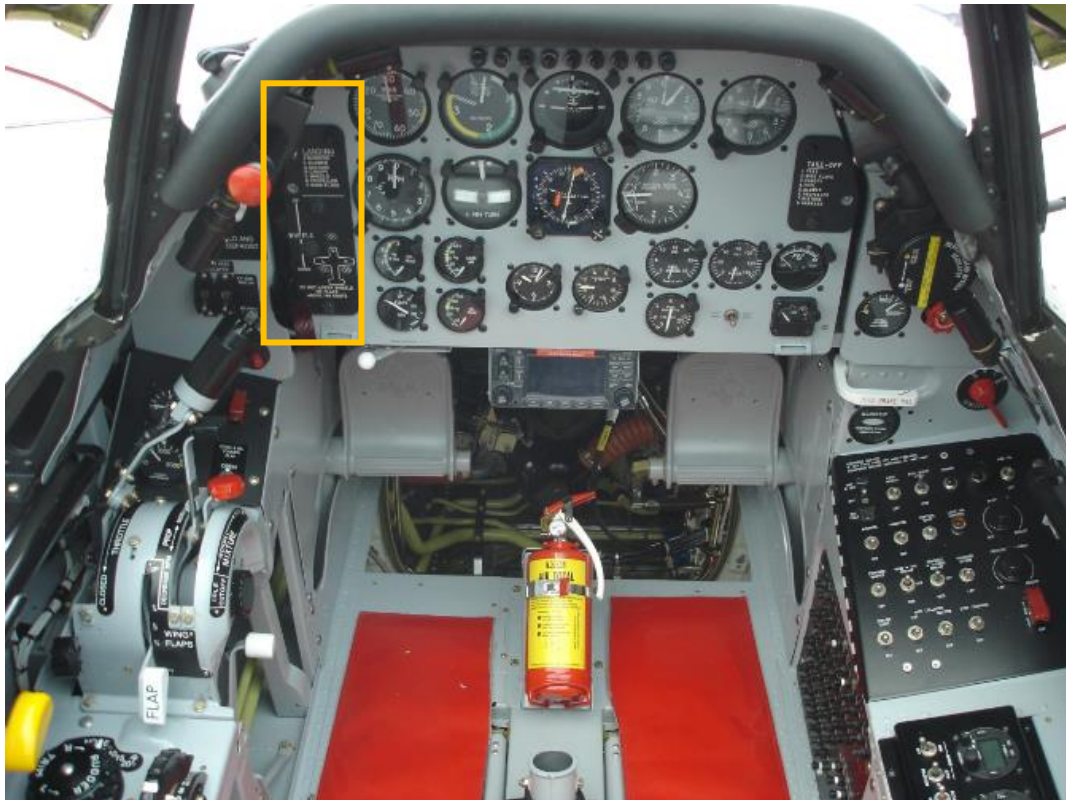
Obr. 7 – Ovládání podvozku ve žlutém rámečku
