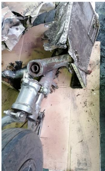
Obr. 15 – Poškození přední podvozkové nohy.
