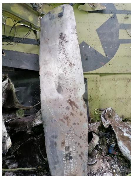
Obr. 12 – List s poškozenými hranami
